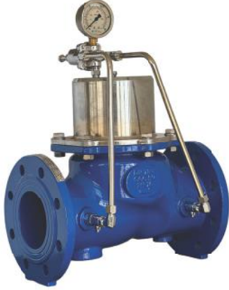
Klape : 1 Bar Açma Basıncı Bağlantı Şekli : FLANŞLI Gövde : GGG50-SFERO DÖKÜM
